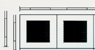
Frontpanel i metall (Coanda) Enkeltversjon: 600x600x40 mm.
